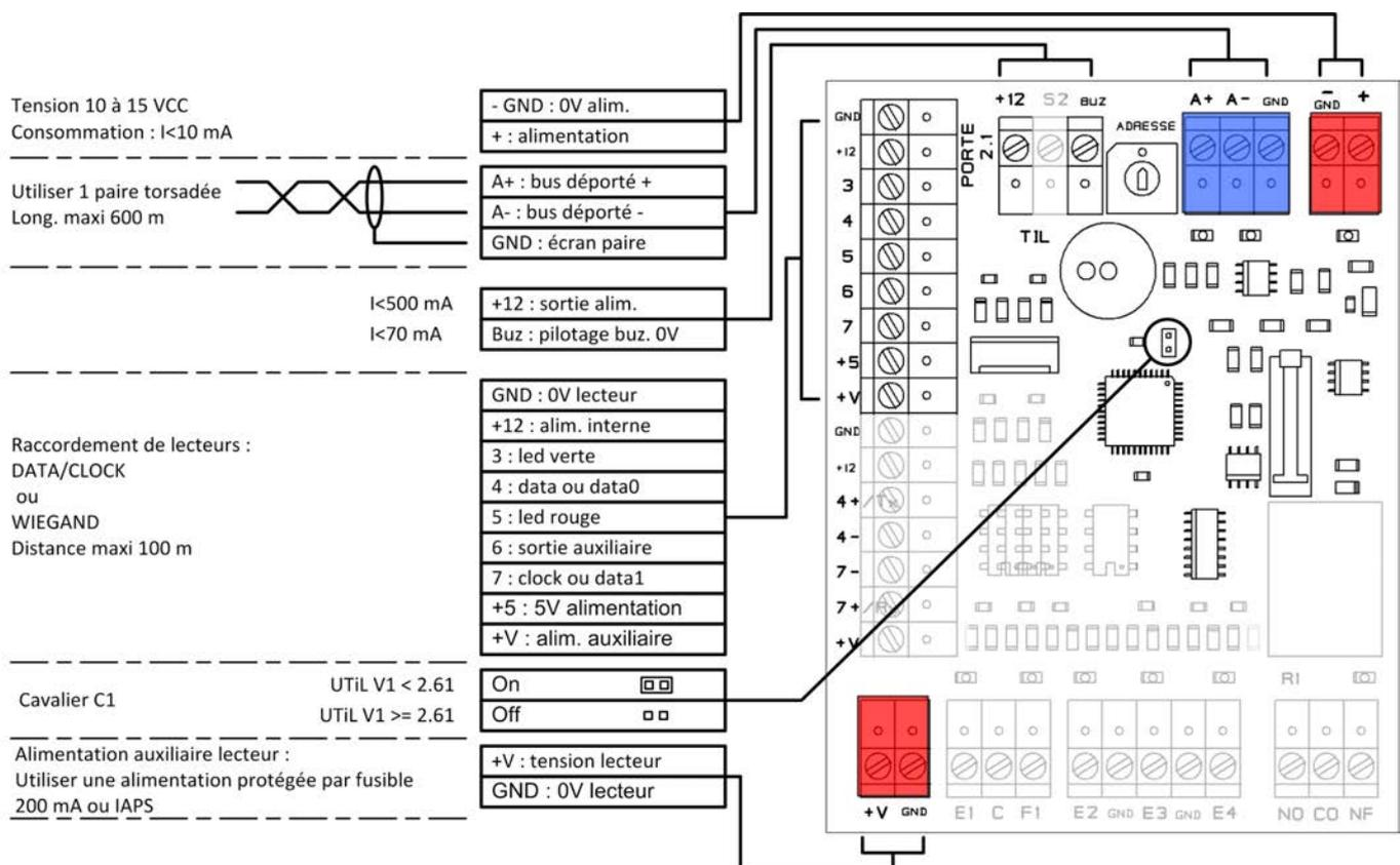
Protection des équipements : Afin d'assurer un parfait fonctionnement des équipements et éviter les interférences, raccorder le 0 volt des cartes électroniques à la terre.
